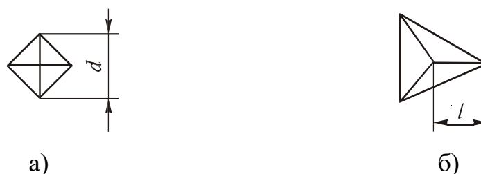
Рис. 5.3. Отпечатки инденторов Виккерса (а) и Берковича (б): d – размер отпечатка по диагонали; l – длина горизонтальной проекции отпечатка
