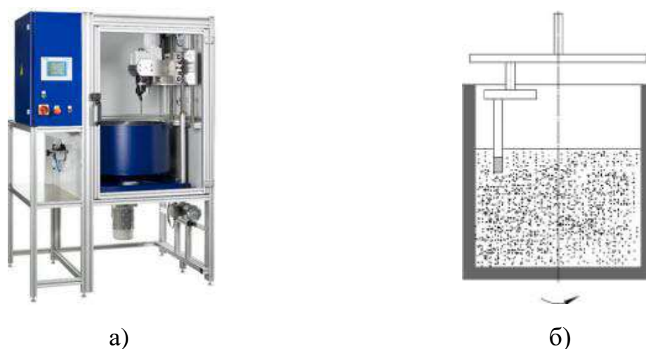
Рис. 4.2. Установка для «сухого» полирования мод. SF-1/1-68 фирмы Otec : а – общий вид; б – схема работы
