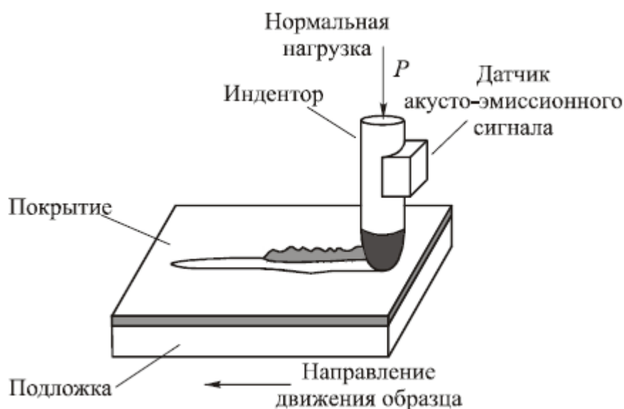
Рис. 5.7. Схема контроля адгезионной прочности покрытия методом скретч–тестирования (царапания)
