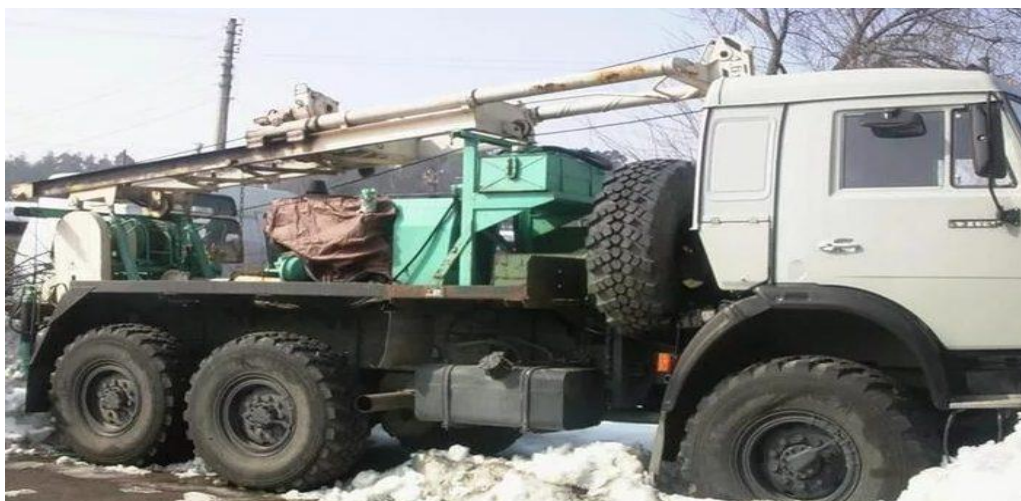
Рисунок 3.3 - Буровая установка ПБУ-2 на базе автомобиля КАМАЗ-5350 6х6
