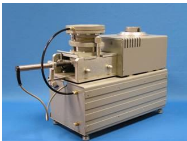
Рисунок 3.8 - Прибор одноплоскостного среза с кинематическим нагружением предназначен для испытания грунтов методом одноплоскостного среза
