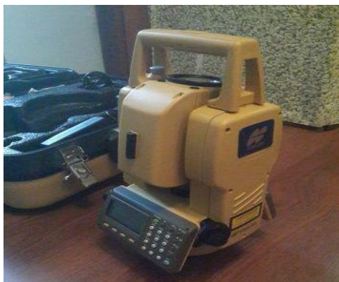
Рисунок 3.2 - Электронный тахеометр Topcon GPT-3105N и отражатель.
