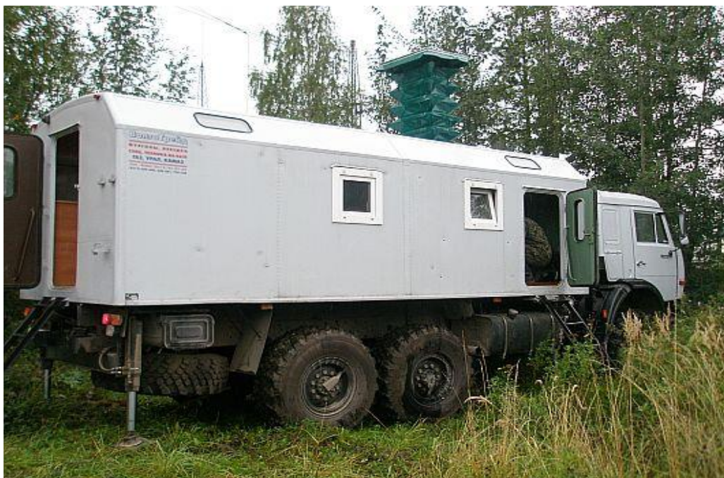
Рисунок 3.4 - Установка статического зондирования УСЗ-15/36А на базе шасси КАМАЗ 43118.
