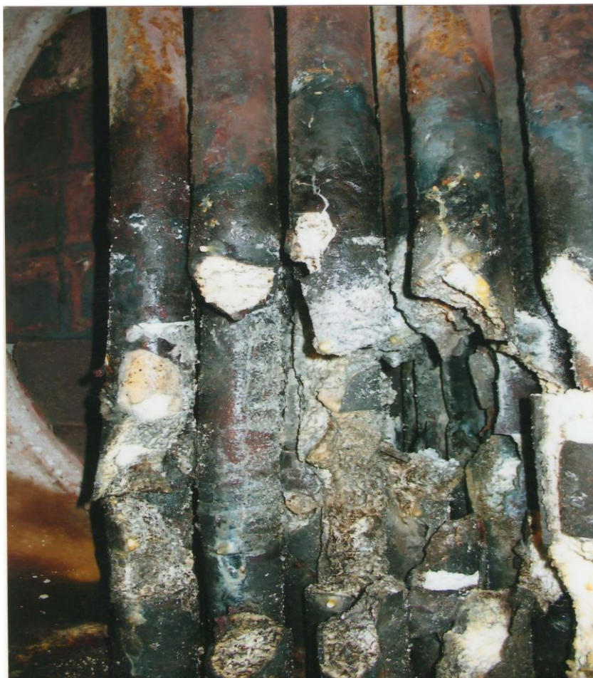
Рисунок 1.4 – Разрыв труб конвективного пучка в результате образования большого количества отложений
