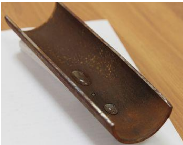
Рисунок – 2.1 Водоотталкивающий эффект вызванный применением пленкообразующих аминов
