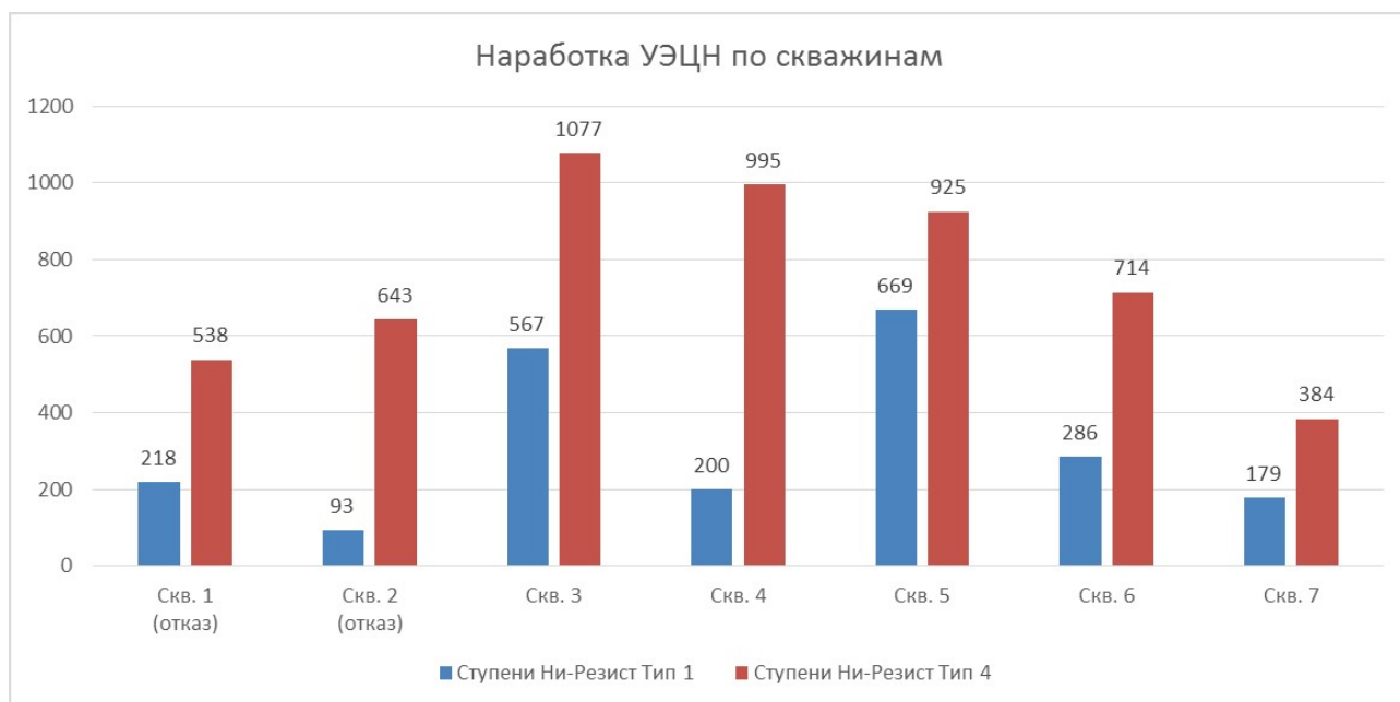
Рисунок 2.2 – Рост средней наработки на отказ за счет внедрения насосов компрессионной сборки с рабочими органами из высоколегированного чугуна НиРезист Тип 4 (стандарт ASTM A436)
