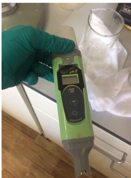
Рисунок 25 – pH-метр “ecotestr pH2”
