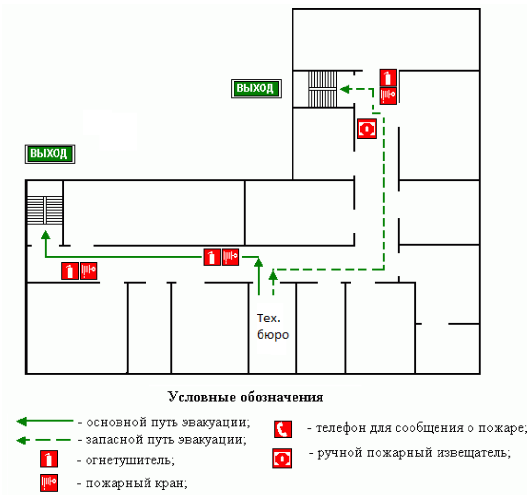
Рис. 2 – План эвакуации из технологического бюро.
