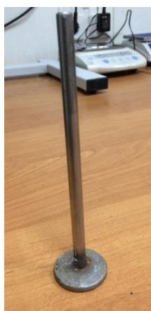
Рисунок Е.2 – Инструмент с плоским профилем для создания абразивного воздействия на образец
