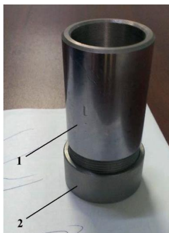
Рисунок Е.1 – Цилиндрический стакан для исследований: 1 – стакан, 2 – крышка-зажим
