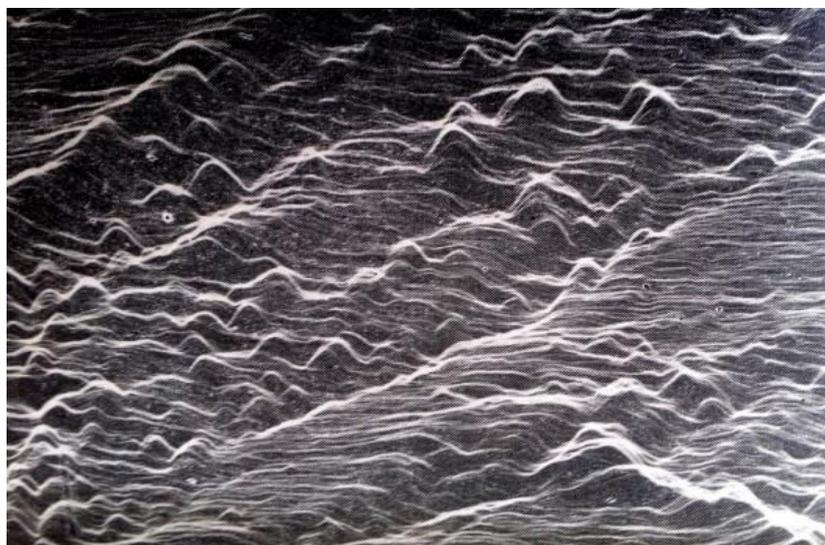
Рисунок 4 – Фото механически обработанной металлической поверхности при увеличении на электронном микроскопе
