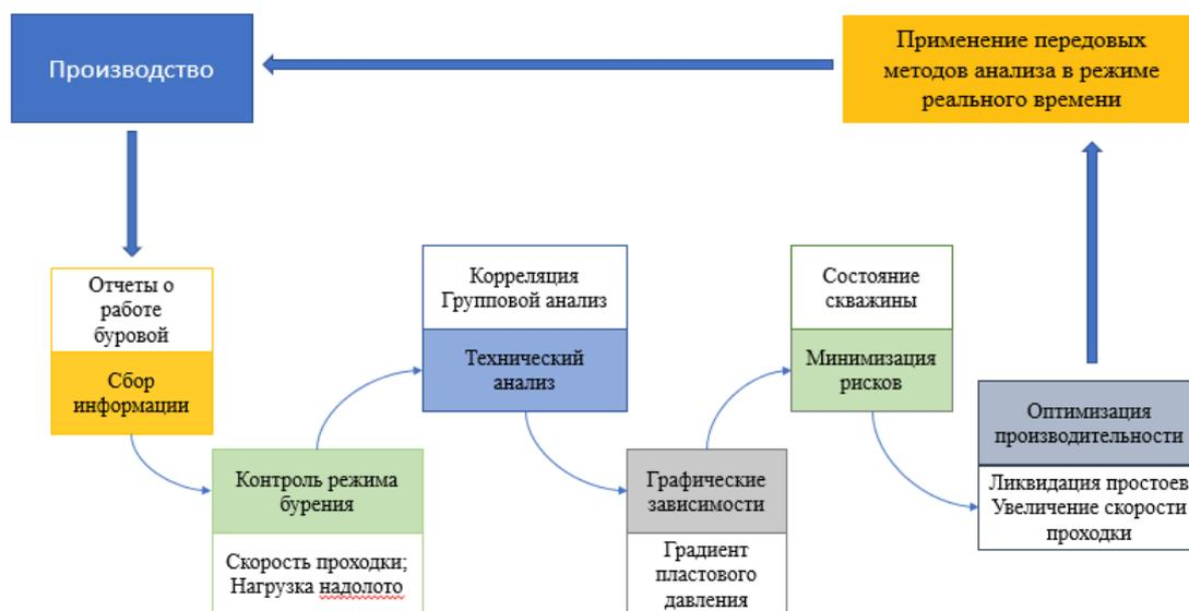
Рисунок 3.4 Обработка данных в режиме реального времени
