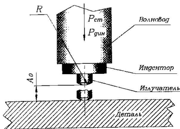
Рис. 3. Схема ультразвуковой стимуляции структурных неоднородностей:  $P_{дин}$  – динамическая сила;  $P_{ст}$  – статическая сила;  $A_0$  – амплитуда колебаний излучателя;  $R$  – радиус сферы излучателя.
