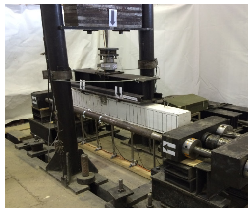
Рис. 2. Стенд при статическом (слева) и кратковременном динамическом(справа) нагружении с распором на податливых опорах.
