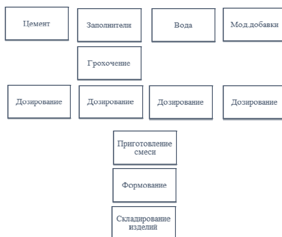
Рис. 1. Технологическая схема производства изделий с помощью 3D-принтера.
