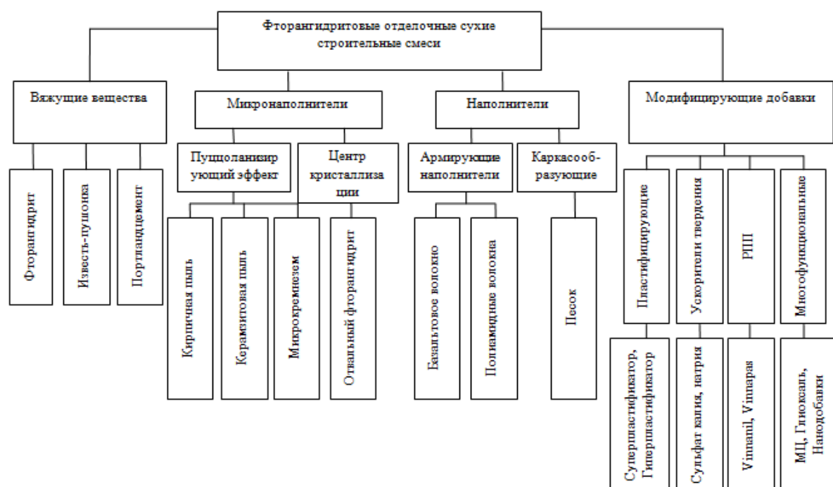
Рис. 1. Способы управления свойствами отделочных сухих строительных смесей
