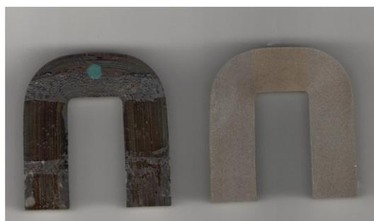
Рис. 4. Ленточные магнитопроводы (слева до обработки, справа после обработки).
