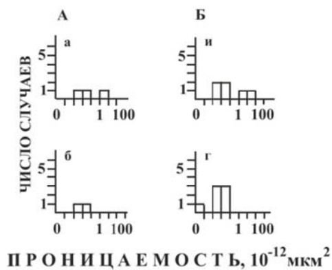
Рисунок 1. Гистограммы распределения значений вертикальной (б, г) и горизонтальной (а, б) проницаемости нижнего (А) и верхнего (Б) элементов циклитов венд-кембрийский и кембрийских литоральных отложений Верхневилючанского месторождения
