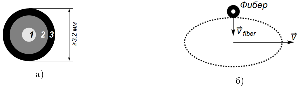
Рис. 1.18 – Пояснение уширения поперечного размера, измеренного фибром: а - поперечное сечение фибера, б - схема взаимодействия пучка с фибром.
