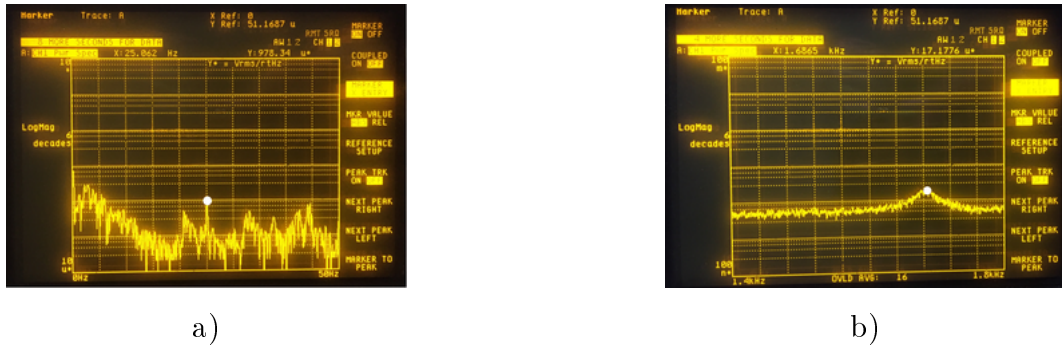
Рис. 3.10 – Снимки экрана анализатора спектра. а - линия 25 Гц, б - линия 1.6 кГц.
