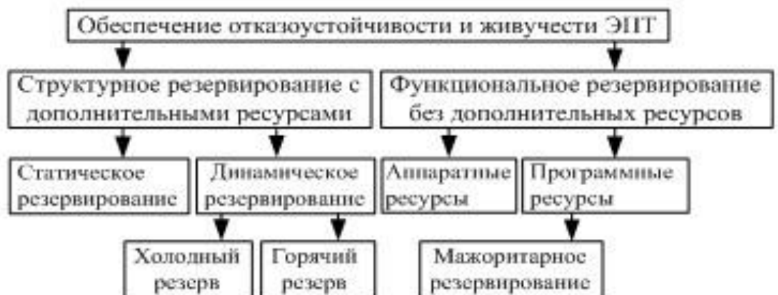
Рис. 2.6. Применение резервирования в ЭПТ
