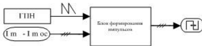
Рис. 3.20. Схема блока ШИМ имитационной модели отказоустойчивого односекционного вентильно-индукторного электропривода
