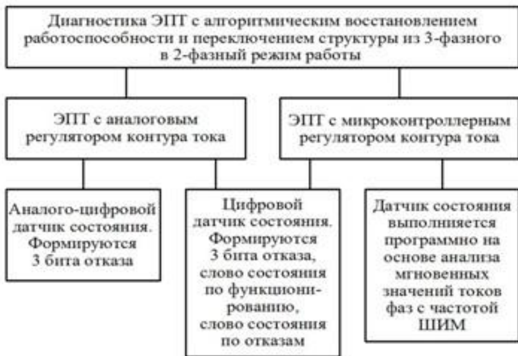
Рис. 6.1. Технические решения датчика состояния ПЯ для мониторинга отказов трехфазных ЭПТ
