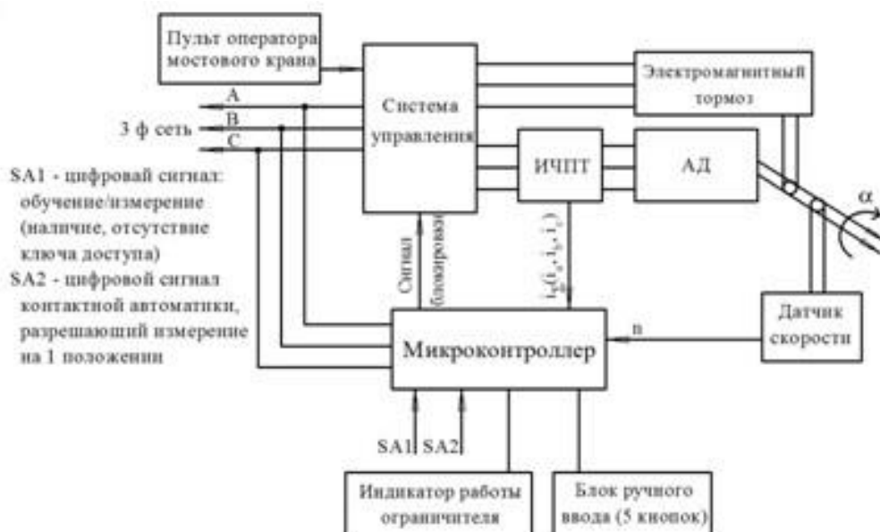
Рис. 7.14. Функциональная схема кранового электропривода с МК ограничителем грузоподъемности и регистратором параметров на основе ИЧПТ
