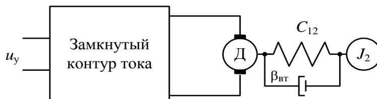
Рис. 3.10. Расчетная схема двухмассовой электромеханической системы
