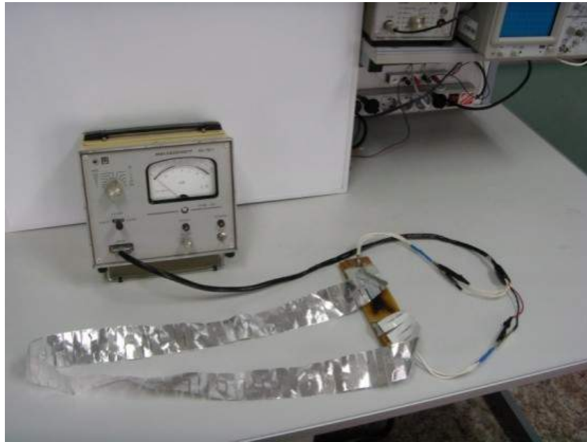
Рисунок 4.17 – Вид экспериментальной установки для определения сопротивления единичной пластины
