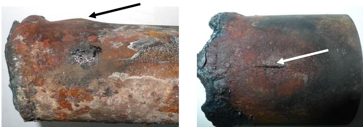
Рисунок 3.16 – Внешний вид повреждения экранной трубы из-за подшламовой коррозии
