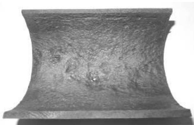
Рисунок 3.21 – Проявления пароводяной коррозии на внутренней поверхности трубы
