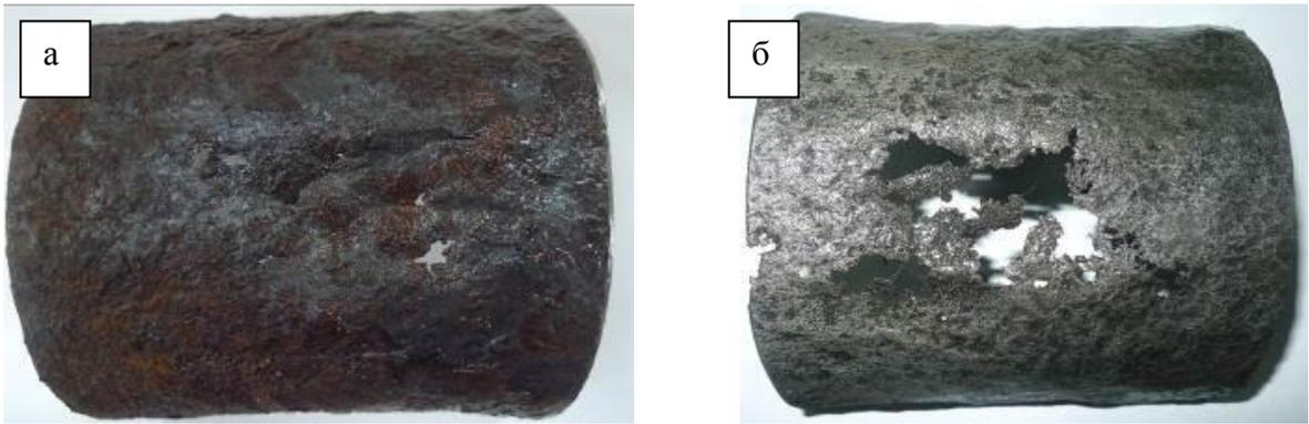
Рисунок 3.7 – Наружная поверхность трубы в месте повреждения (а) и после удаления коррозионных отложений (б)
