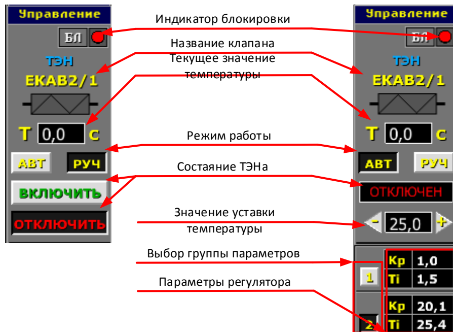
Рисунок 4.20 – Мнемосхема управления регулятором температуры 1 выпарного аппарата АВ2
