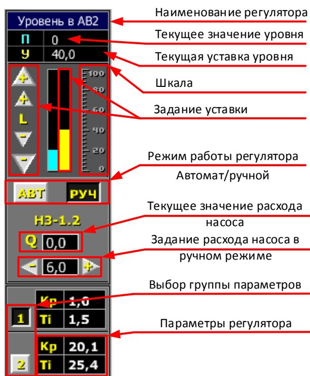
Рисунок 4.16 – Мнемосхема управления регулятором уровня раствора в камере разделения выпарного аппарата АВ2
