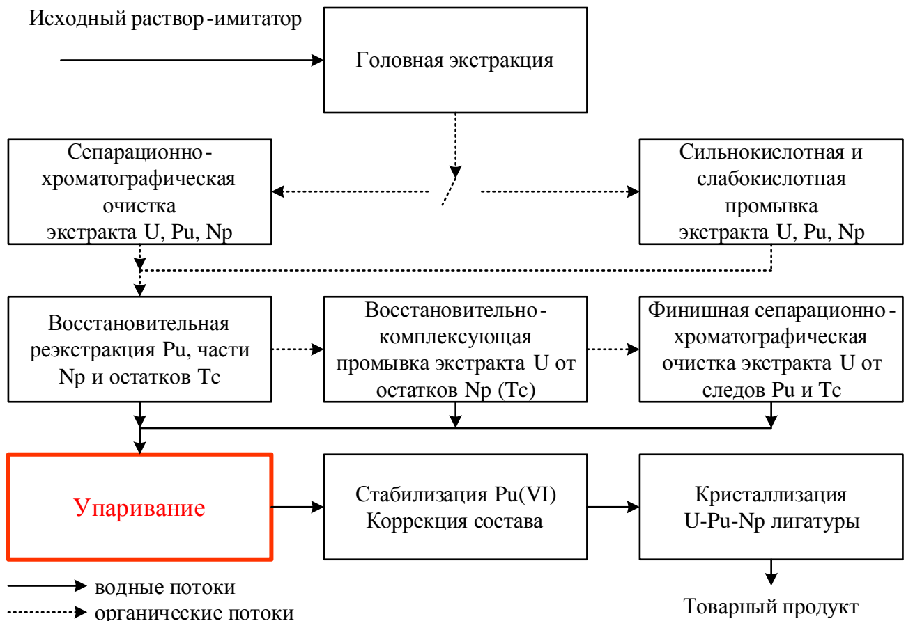
Рисунок 1.1 – Укрупненная схема аффинажного стенда отработки экстракционно-кристаллизационной технологии переработки ОЯТ РУ БРЕСТ-ОД-300
