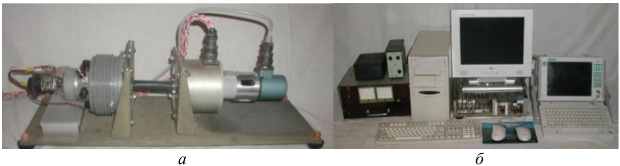
Рис. 13. Испытательный стенд на основе ВД (а) и система управления ВД с регистратором параметров (б)
