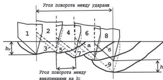
Рис. 3. Механизм разрушения горной породы при вращательно-ударном бурении [15]
