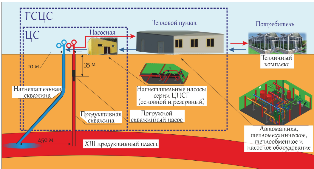
Рис. 1. Схематический рисунок геотермальной циркуляционной системы отбора тепла на Ханкальском месторождении [10]
