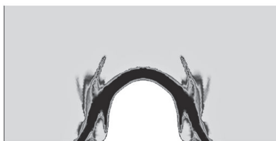
Рис. 4. Топология оптимального укрепления для оптимальной формы свода
