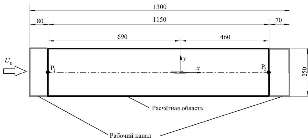
Рис. 1. Схема рабочего канала с установленным в него гидрокрылом (масштаб выдержан) и относительное положение расчетной области
