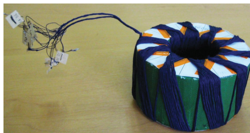
Рис. 3. Декада с намоткой типа секционная универсаль
