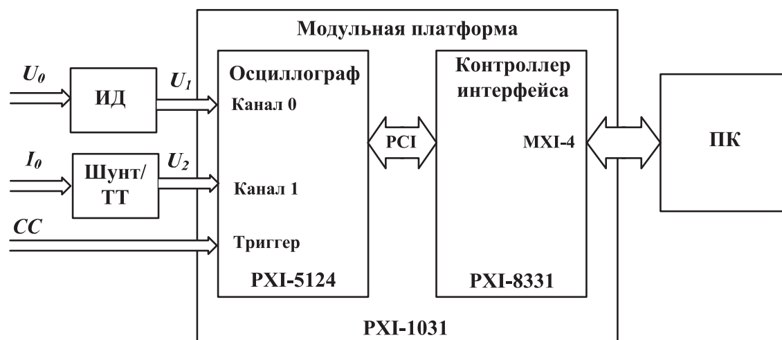
Рис. 1. Структурная схема цифрового измерителя мощности ЦИМ-1.1
