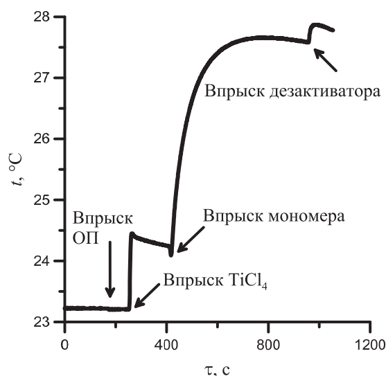
Рис. 4. Типичная термометрическая кривая полимеризации при одновременном добавлении мономера в раствор каталитической системы в толуоле (инверсный способ дозирования). Адиабатический реактор, мономер – дициклопентадиен 1,16 моль/л; катализатор – система \text{TiCl}_4 + ОП с концентрацией 8,93 \cdot 10^{-3} моль/л
