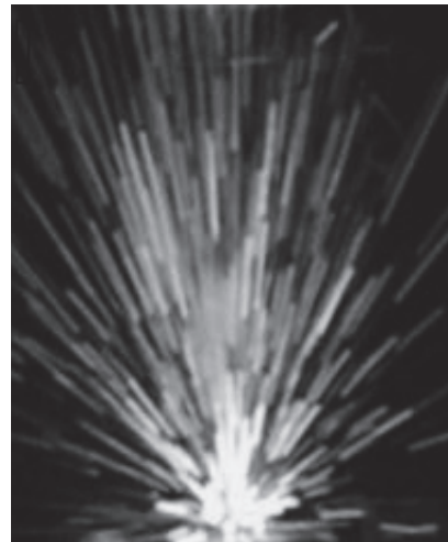
Рис. 2. Фотография факела горящего прессованного образца термитной смеси (25 % НП алюминия + 75 % НП \text{Fe}_2\text{O}_3 )
