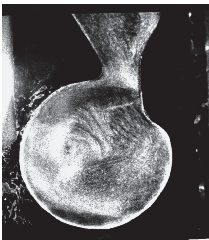
Рис. 2. Визуализация течения в модели ПВТ с помощью ультрадисперсных порошков
