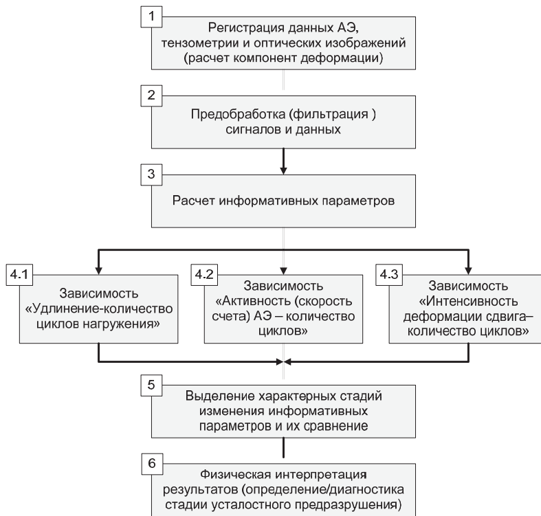
Рис. 2. Блок-схема алгоритма регистрации, обработки и анализа информации в стенде комбинированного исследования усталостного разрушения
