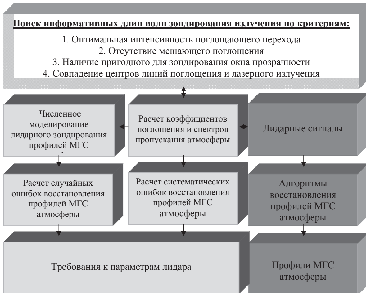
Рис. 1. Схема алгоритма планирования и проведения лидарных измерений профилей МГС атмосферы
