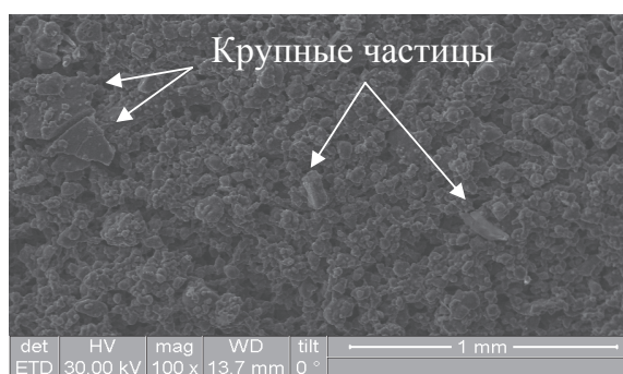
Рис. 1. Микроскопическое изображение электропроводящей смеси (МО 40 мин после выдержки в печи полимеризации в течение 3 мин)
