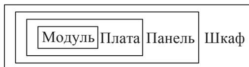
Рис. 1. Иерархия конструктивных узлов
