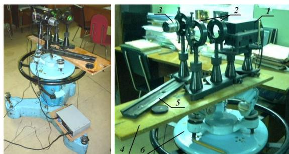
Рис. 1. Общий вид оптико-электронного узла: 1 – лазер LCS-DTL-317-50; 2 – расширитель пучка; 3 - телекамера; 4 – рабочий стол; 5 – оптическая линейка; 6 – подвижный телевизионный штатив
