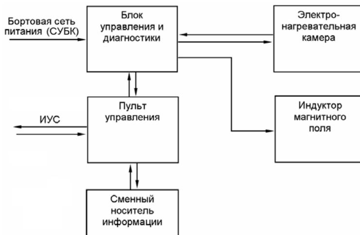
Рис. 1. Блок-схема научной аппаратуры «Ростовая установка»
