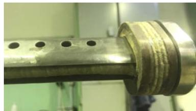
Рис. 3. Опытный образец производственного штампа с индуктором для реализации комбинированной технологии «вытяжка-обрезка припуска»
