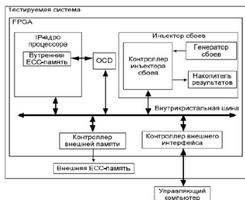
Рис. 1. Концептуальная архитектура FI-метода для SoC-процессоров
