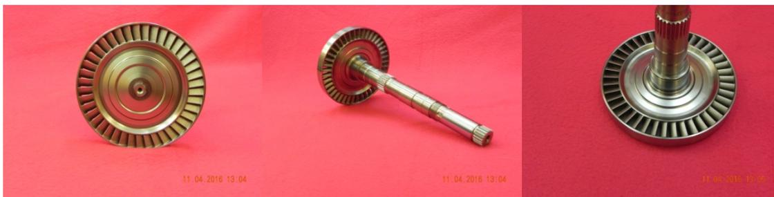
Рис. 1 Внешний вид детали после мех. обработки
