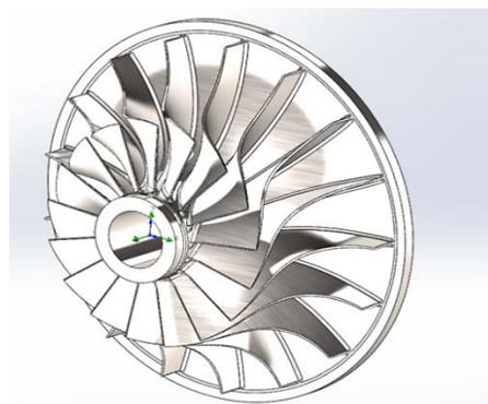
Рис. 2. Модель рабочего колеса 3D
