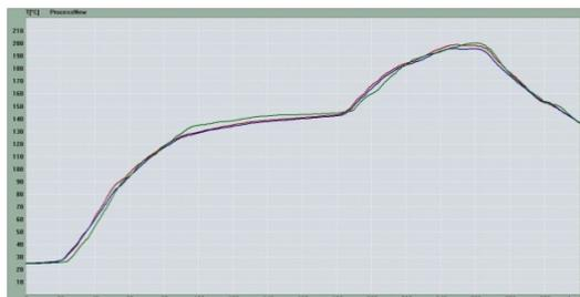
Рис. 1. Термопрофиль паяльной пасты 7071
