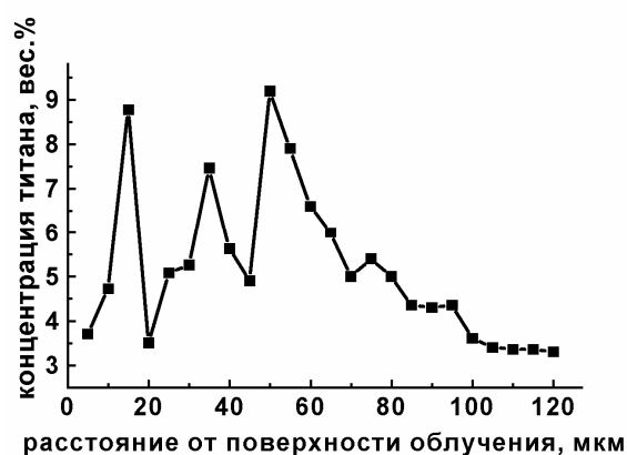
Рис. 5. Концентрационный профиль распределения титана в металлической связке металлокерамики после ее обработки электронным пучком
