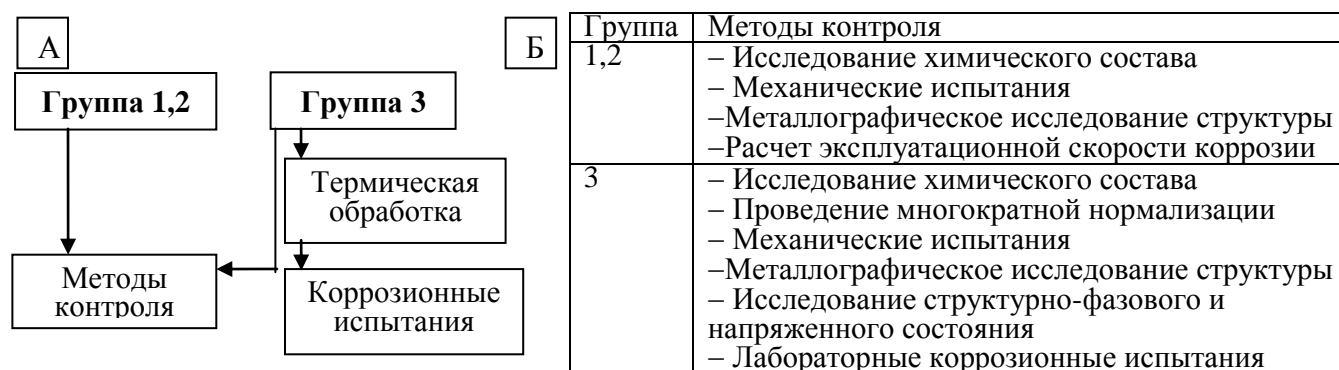
Рисунок 1 – Схема (А) и виды (Б) испытаний образцов по группам труб
