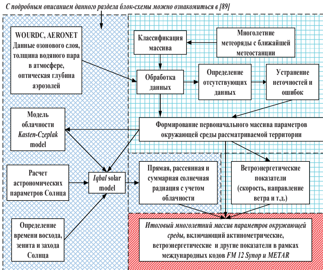
Рис. 2. Блок-схема укрупненно описывающая основные этапы работы ПВК «Локального анализа параметров окружающей среды и солнечной радиации»
