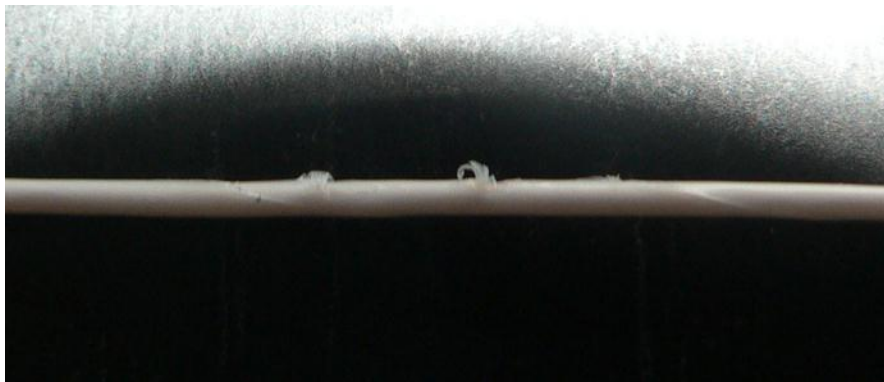
Рисунок 3 – Механическое повреждение изоляции
