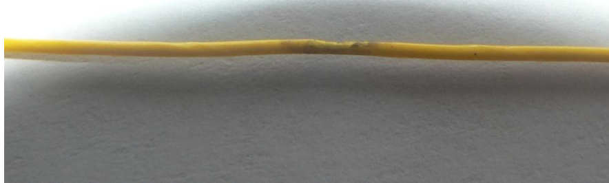
Рисунок 2 – Инородные включения, локальное уменьшение толщины изоляции
