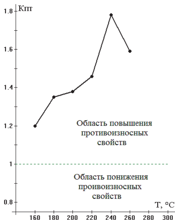
Рисунок 3.22 – Зависимость коэффициента влияния предварительного термостатирования синтетического моторного масла Mobil Super 30005W-40 SJ/SL/SK/CF от температуры термостатирования
