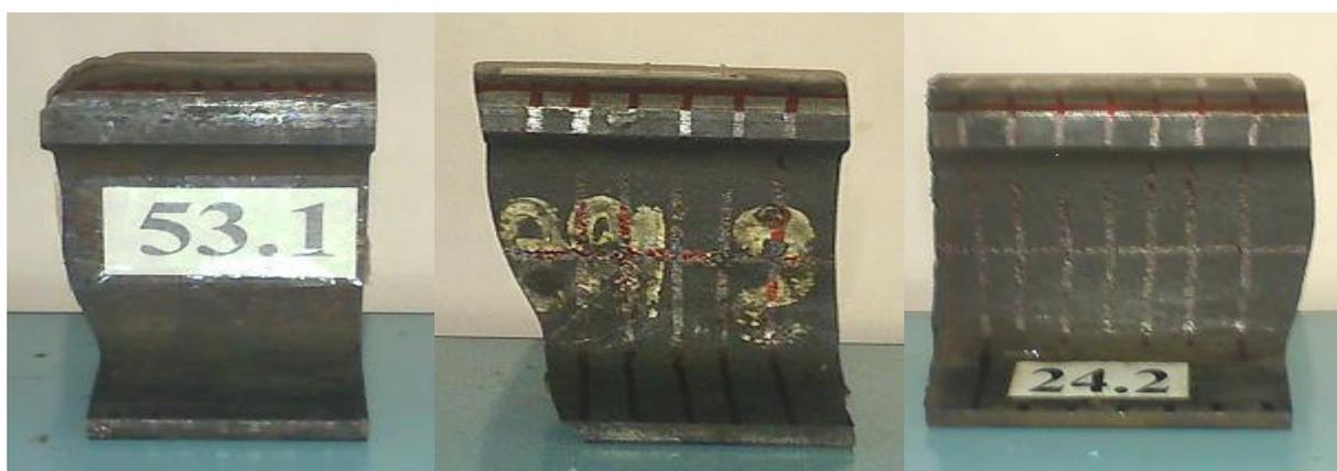
Рисунок 4.13 – Образцы рельсов с изломами по месту дефектов
