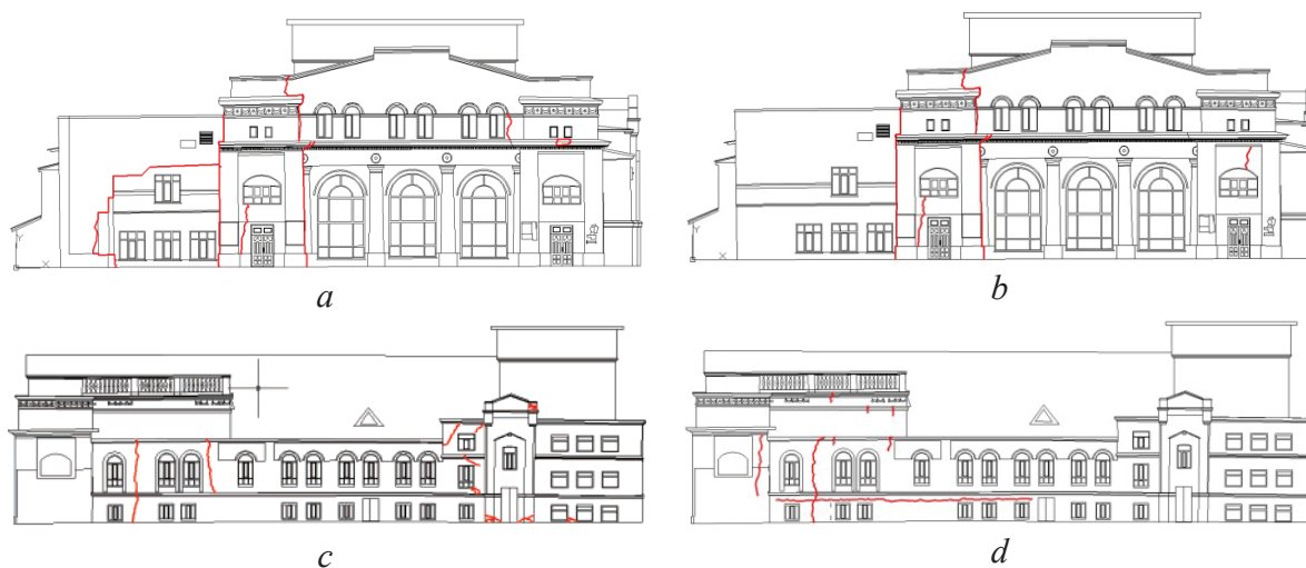
Рис. 9. Трещины фасадов: главного: а) 2012 г.; б) 2017 г.; северного: с) 2012 г.; д) 2017 г.
