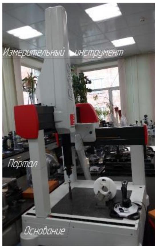
Рисунок 40. Координатно-измерительная машина
