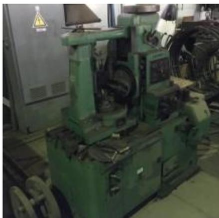
Рисунок 38. Универсальный зубофрезерный станок 5310
