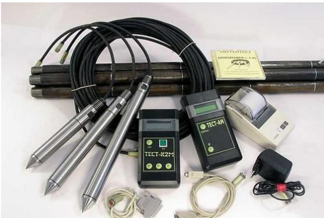
Рисунок 3.3.4 Комплект аппаратуры ТЕСТ-K2M
