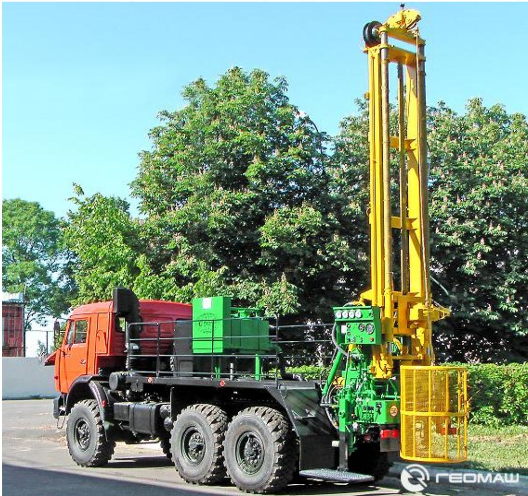
Рисунок 3.3.2 Буровая установка ПБУ-2 на базе автомобиля КАМАЗ.
