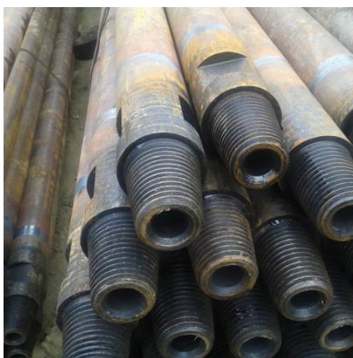
Рисунок 18 – Бурильные трубы ТБСУ П 55х4.5 [10].
