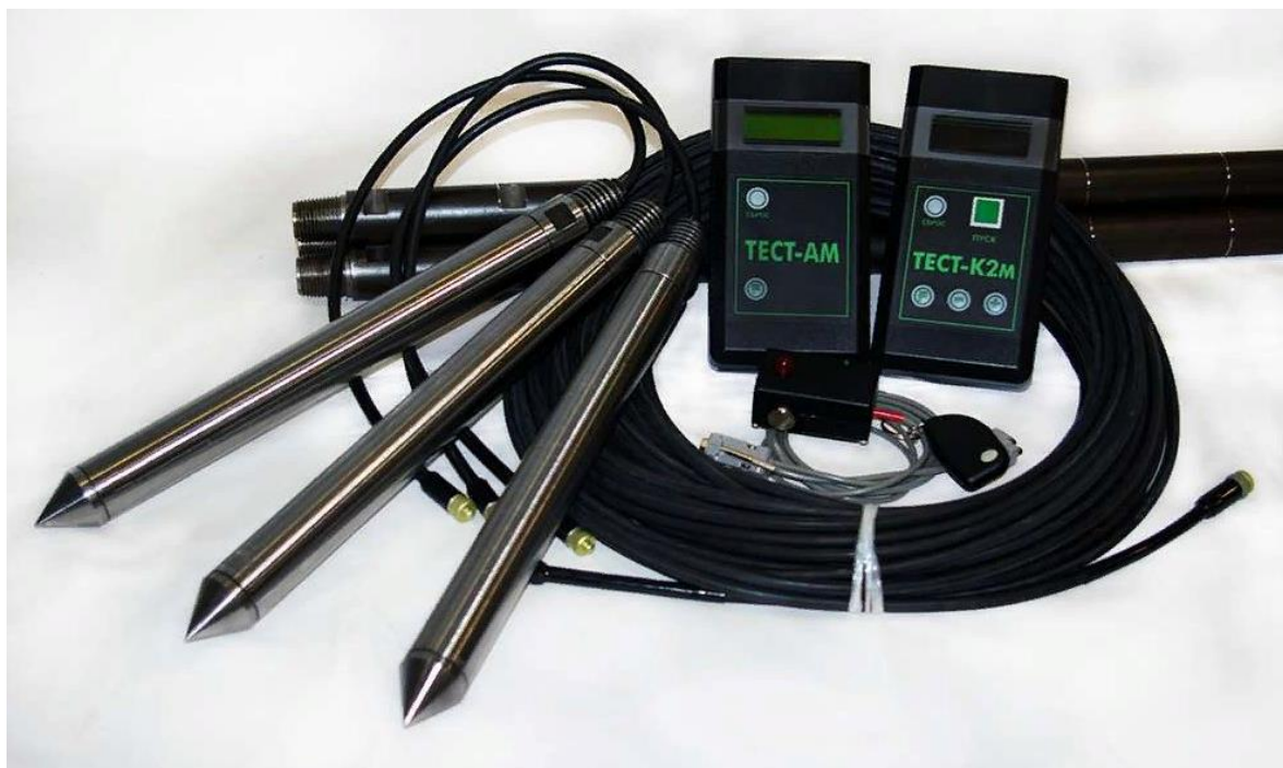
Рисунок 28 – Комплект аппаратуры для статического зондирования грунтов ТЕСТ-К2М [10]
