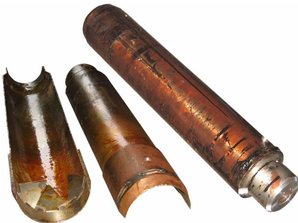
Рисунок 19 – Грунтонос задавливаемый ГК-123 [10].
