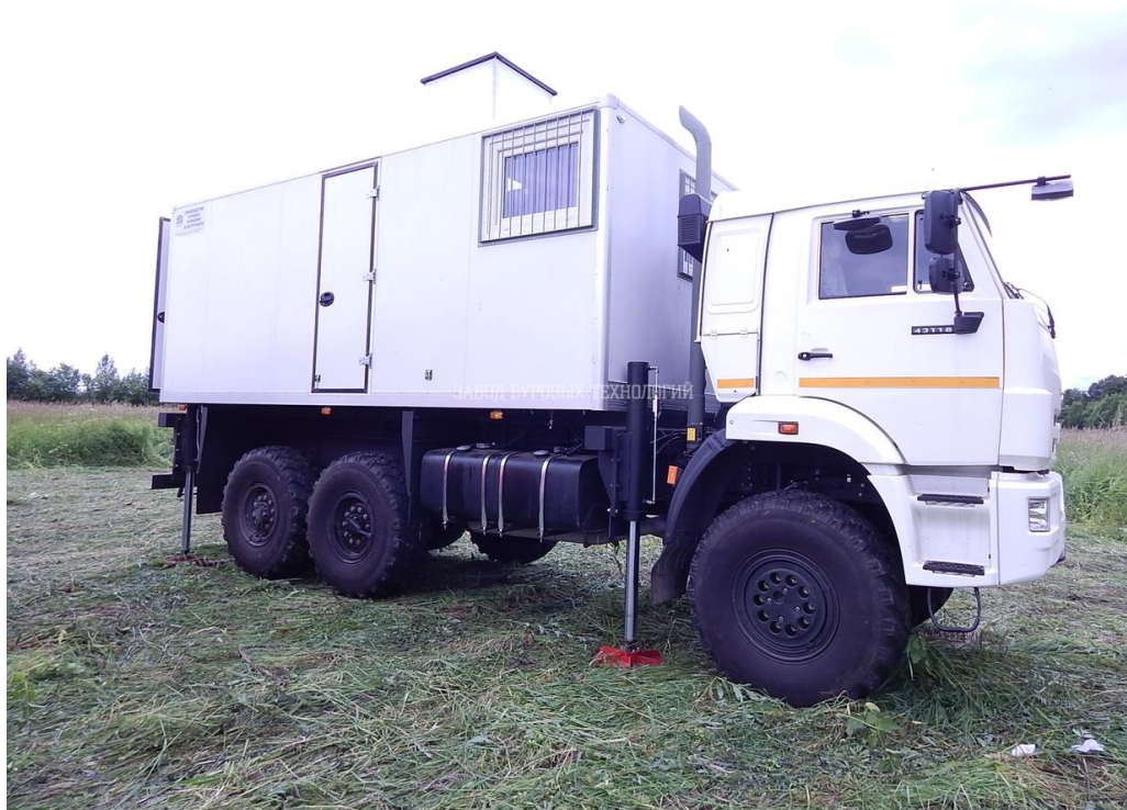
Рисунок 27 – Установка статического зондирования УСЗ 15/36А на базе шасси КАМАЗ 43118[10].
