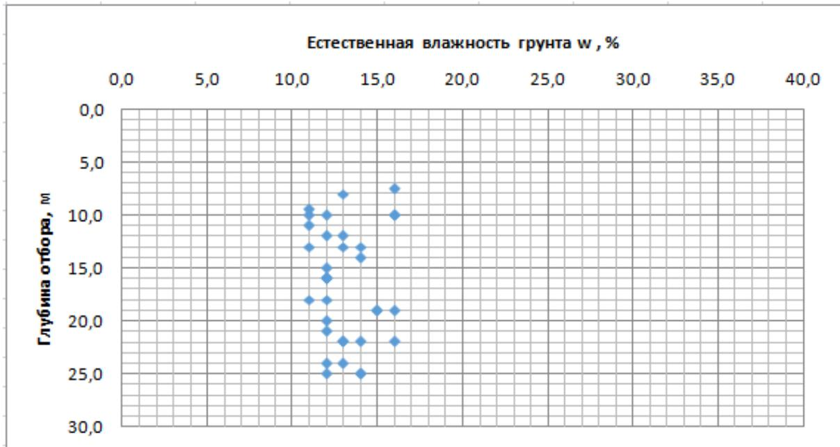
Рисунок 2.9 – Изменение естественной влажности суглинка легкого пылеватого твердого непросадочного с дресвой 24,5% ( $e$ ,  $de$ ?) с глубиной.
