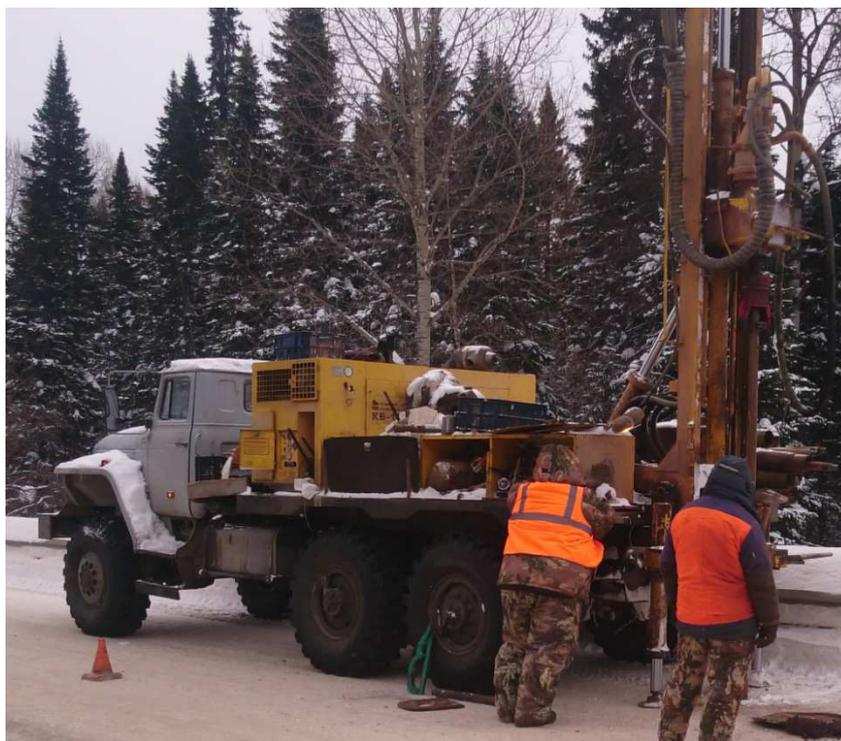
Рисунок 3.4 – Буровая установка УРБ-2А-2 на базе Урал-4320-0111-43 в работе [49].
