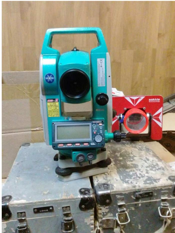
Рисунок 3.2 – Тахеометр SOKKIA и отражатель APS 12 [49].
