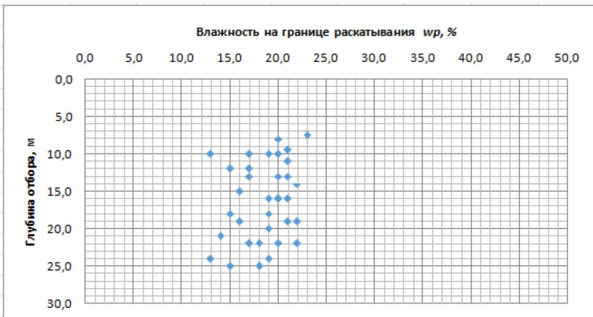
Рисунок 2.11 – Изменение влажности на границе раскатывания суглинка легкого пылеватого твердого непросадочного с дресвой 24,5% ( $e$ ,  $de$ ?) с глубиной.
