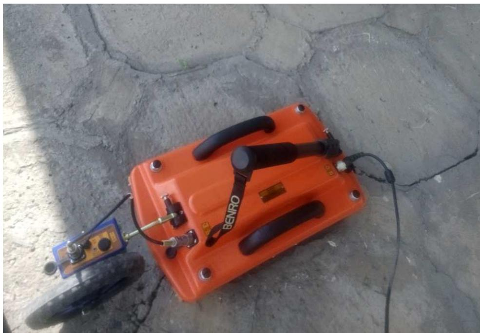
Рисунок 3.9 – Антенный блок АБ400 с присоединенным датчиком перемещения ДП-32 [49].
