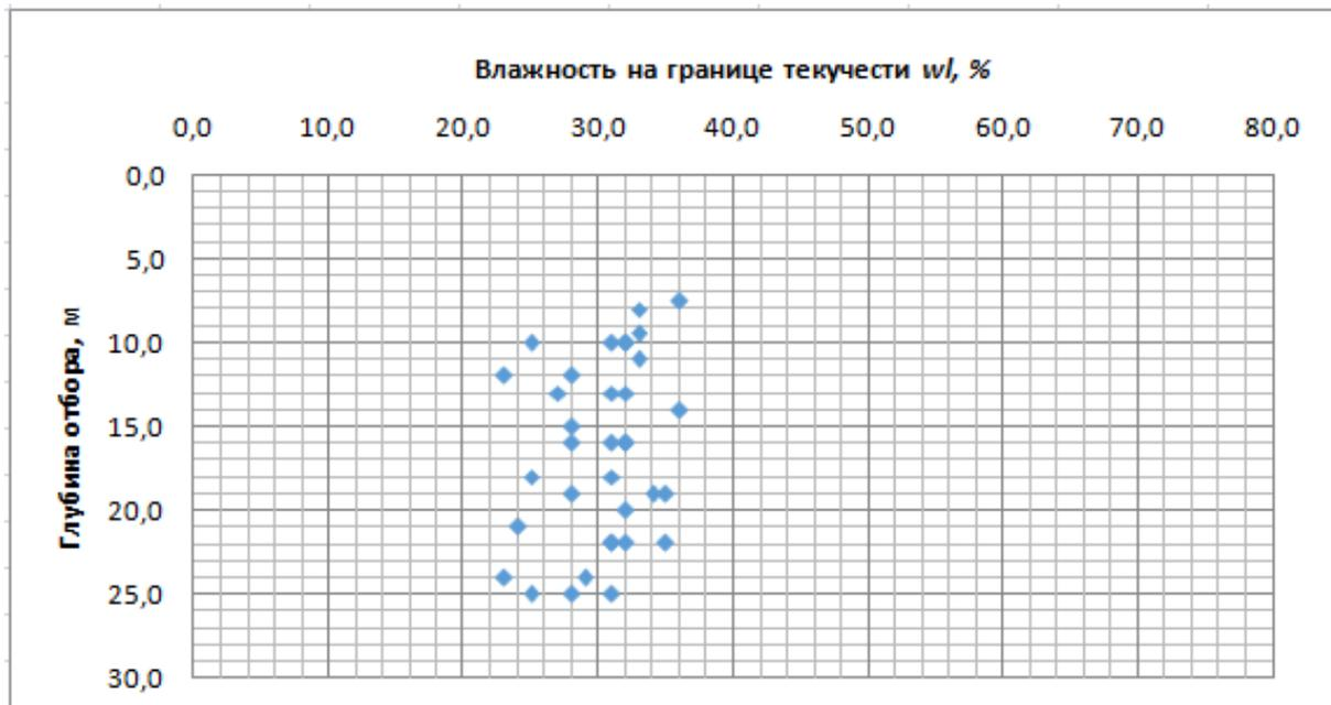
Рисунок 2.10 – Изменение влажности на границе текучести суглинка легкого пылеватого твердого непросадочного с дресвой 24,5% ( $e$ ,  $de$ ?) с глубиной.
