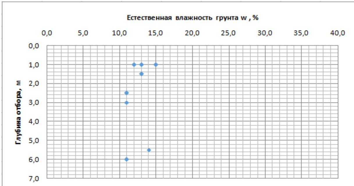
Рисунок 2.1 – Изменение естественной влажности суглинка тяжелого песчанистого твердого непросадочного с дрсвой 16,2 % ( $e$ ,  $de$ ?) с глубиной.
