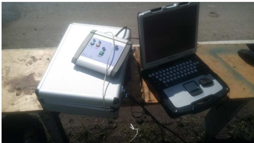
Рисунок 3.6 – Блок связи БС-3 и персональный компьютер Panasonic CX-30 в качестве регистратора данных при испытании [49].
