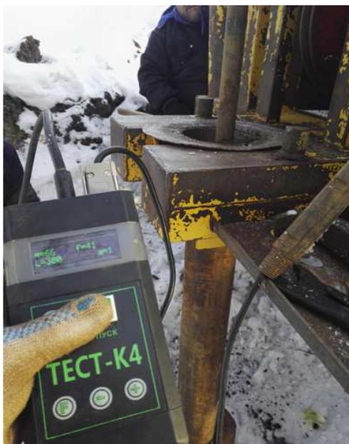
Рисунок 3.7 – Мобильный регистратор "Тест К4" с данными зондирования [49].
