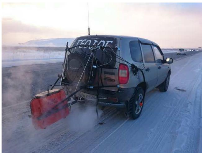
Рисунок 3.8 – Георадиолокационный антенный блок АБ1000 на автомобильном подвесе с закрепленным на колесе датчиком перемещения [49].
