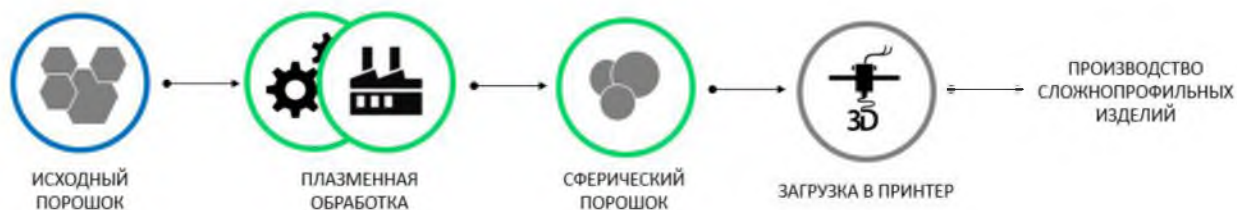
Рисунок 7 – Технологическая схема получения сложнопрофильных изделий аддитивными технологиями, с использованием плазменной сфероидизации стандартных металлических порошков
