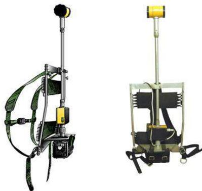
*Рисунок 8.1.4.1 – Магнитометр портативный протонный МИНИМАГ[45]*
