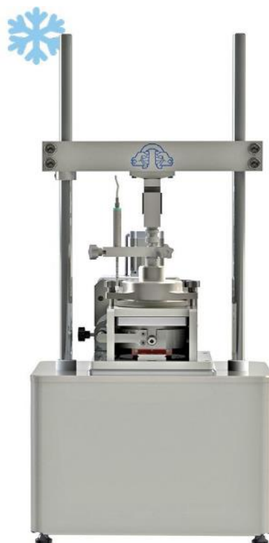
Рисунок 39 – Прибор одноплоскостного среза для испытания мерзлых грунтов
