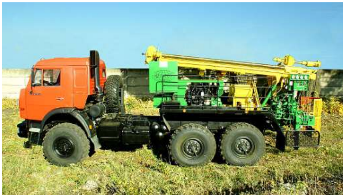
Рисунок 3.4.1 – Буровая установка ПБУ-2
