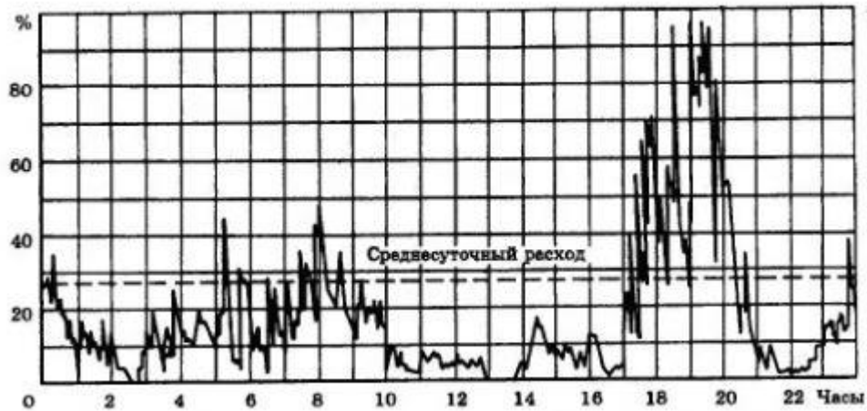
Рисунок 2. – Суточный график расхода горячей воды в жилом доме [1].
