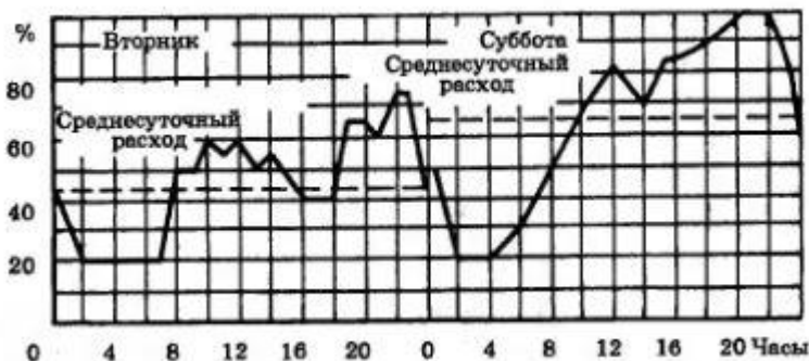
Рисунок 3. – График горячего водоснабжения жилого района (суточный) [1].
