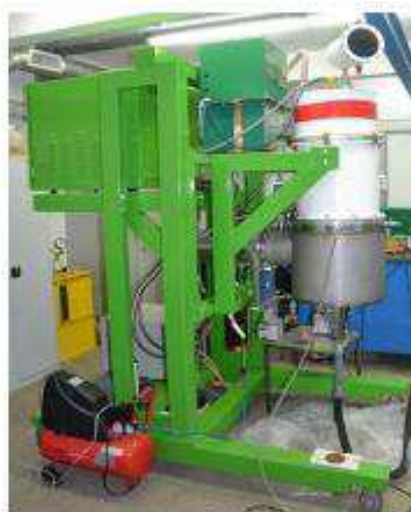
Рис. 2.1. Внешний вид ускорителя электронов «АСТРА-М»
