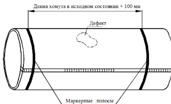
Рисунок 3.11 - Нанесение маркерных полос для выравнивания муфты при монтаже
