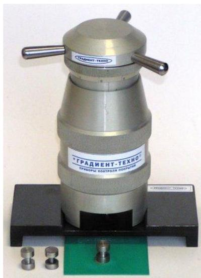
Рисунок 2 – Адгезиметр ОР
