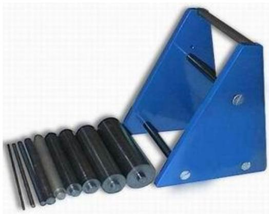
Рисунок 4 - Прибор для определения прочности на изгиб
