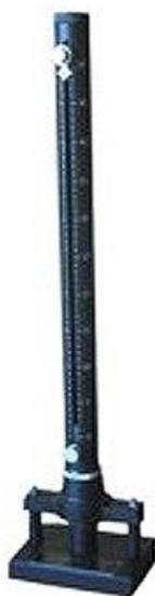
Рисунок 3 – Прибор для измерения прочности при ударе У-1А
