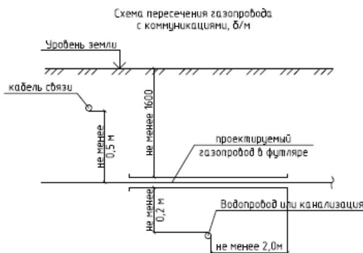
Рисунок 2 – Схема пересечения газопровода с коммуникациями [34]
